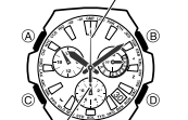
Lancetta dei secondi dell'indicazione dell'ora Posizione iniziale corretta della lancetta dei secondi dell'indicazione dell'ora e della lancetta dei secondi del cronometro
