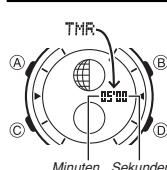
Der Countdown-Timer kann in einem Bereich von einer Minute bis zu 60 Minuten eingestellt werden. Ein Alarm ertönt, wenn der Countdown Null erreicht. Der Countdown-Timer weist auch eine Wiederholungsautomatik und einen akustischen Ablaufsignalgeber auf, der den Ablauf des Countdowns signalisiert.
