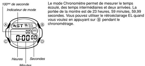
Le mode Chronomètre permet de mesurer le temps écoulé, des temps intermédiaires et deux arrivées. La portée de la montre est de 23 heures, 59 minutes, 59,99 secondes. Vous pouvez utiliser le rétroéclairage EL quand vous voulez en appuyant sur **B** pendant le chronométrage.
